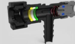
Das RG\* Ventil wird verwendet, wenn ein Zugang zum Leitungssystem zur Wartung oder Diagnose benötigt wird. Das Ventil wird manuell geöffnet oder geschlossen und ermöglicht die Zuführung und Entnahme eines Mediums so wie Druckprüfungen.
